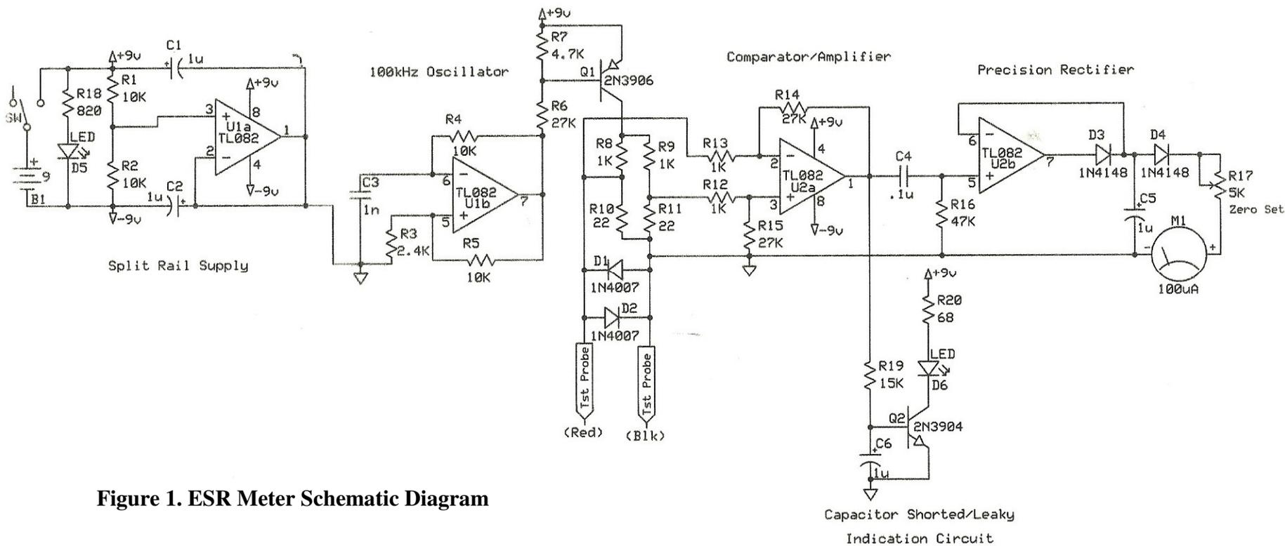
Figure 1. ESR Meter Schematic Diagram
