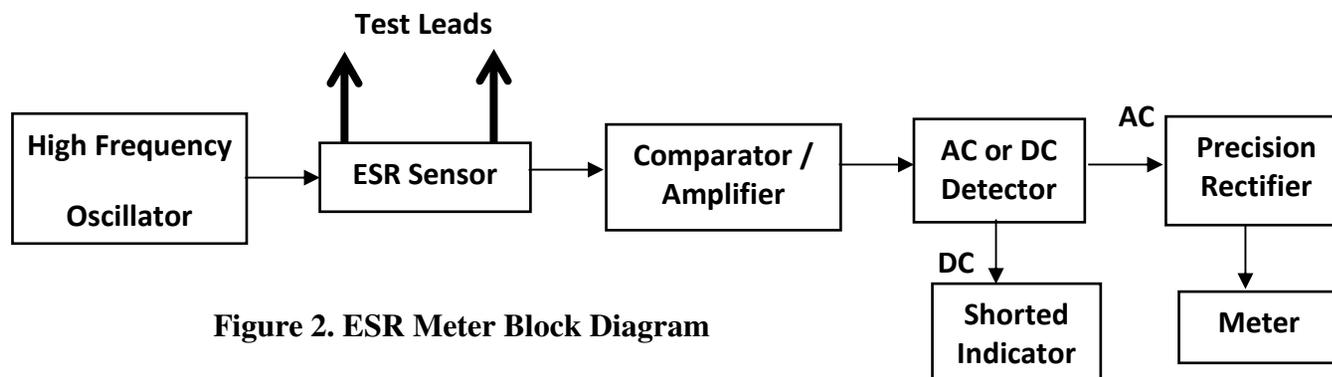
Figure 2. ESR Meter Block Diagram
